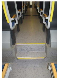
Treppe zw. Niederflur- und Hochflurbereichen
